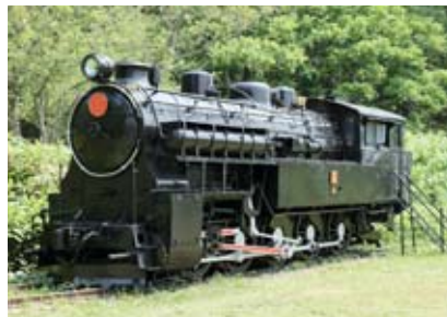
市の指定文化財名は、「4110形式十輪連結タンク機関車2号」で、動輪が5軸10輪あり、急勾配に強い機関車です。
